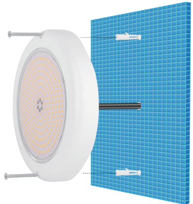
安装指引图 (Installation guide drawing)
